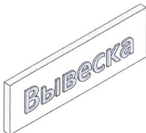
**Вывеска с подложкой** — конструкция, в которой элементы (текст или логотип) размещаются на панели или основе, обычно выполненной из пластика, металла или дерева. Используется в случаях необходимости для фасадов ненадлежащего вида.
