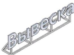
**Надкрышная (крышная) конструкция** — это вид рекламной конструкции, устанавливаемой на крыше или кровле здания.
